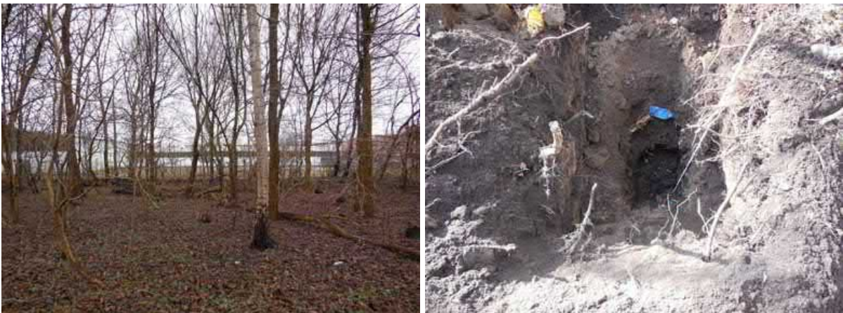
Abbildung 6: Linkes Bild: Bereich der ehem. Deponie, Flurstück 63 (Schürfe und KRB 20 -22), Rechtes Bild: Blick in Schurf 6, ab ca. 1,2 m u. GOK deutliche Hausmüllbeimengungen
